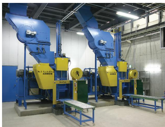
写真3 ペットボトル圧縮梱包機
